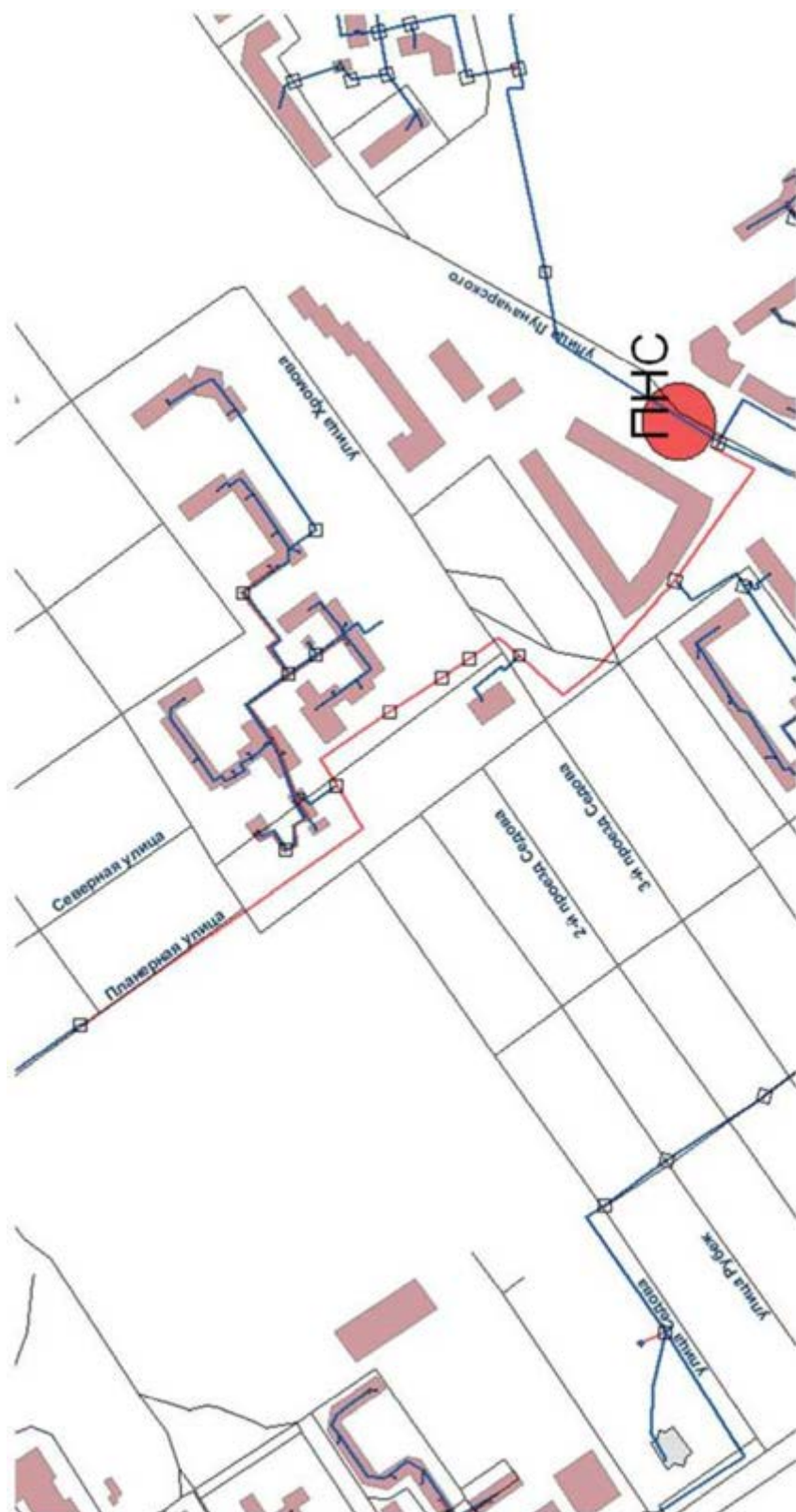
Рисунок 7.8.1 - Обустройство и перекладка сетей микрорайоне «Юность»
