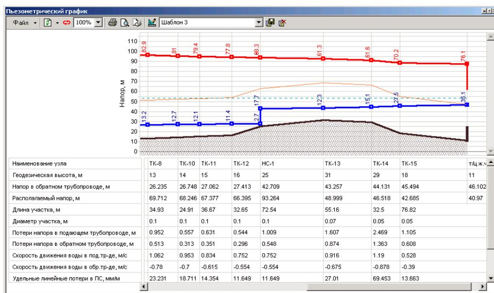
Рисунок 21 - Пример пьезометрического графика
