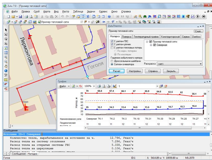
Рисунок 17 - Расчет системы теплоснабжения
