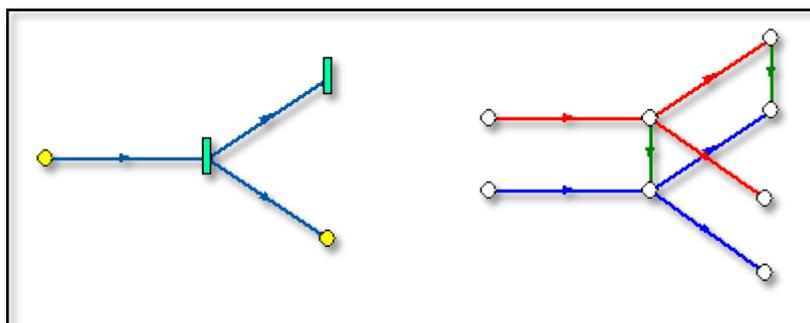
**Рисунок 9** - Перемычка во внешнем и внутреннем представлениях
