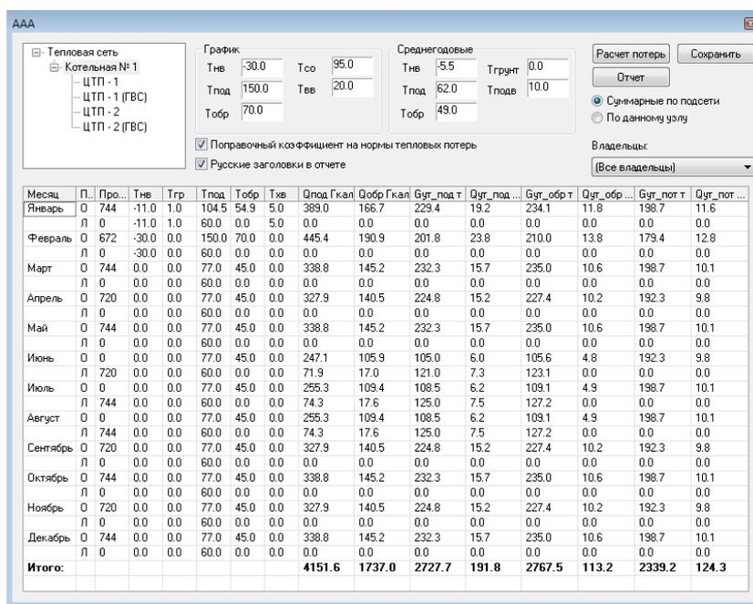
Рисунок 19 - Расчет нормативных потерь тепловой энергии через изоляцию
