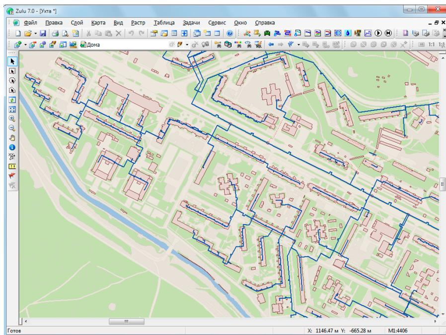
**Рисунок 18** - Моделирование сетей. Используя модель сети можно решать ряд топологических задач: поиск кратчайшего пути, анализ связности, анализ колец, анализ отключений, поиск, поиск ближайшей запорной арматуры, отключающей участок от источников, или полностью изолирующей участок и т. п.
