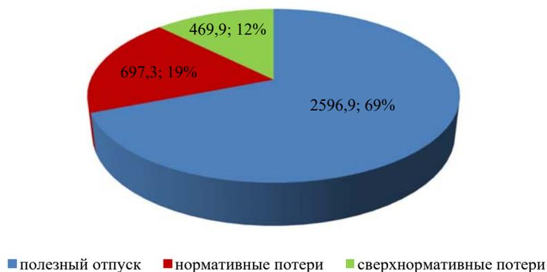
**Рисунок 5.4.3** Баланс тепловой энергии (теплоноситель «вода»), тыс. Гкал (зеленым цветом обозначены сверхнормативные потери)
