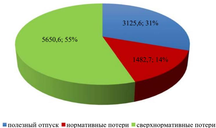
**Рисунок 5.4.4** Баланс теплоносителя «вода», тыс. м3
